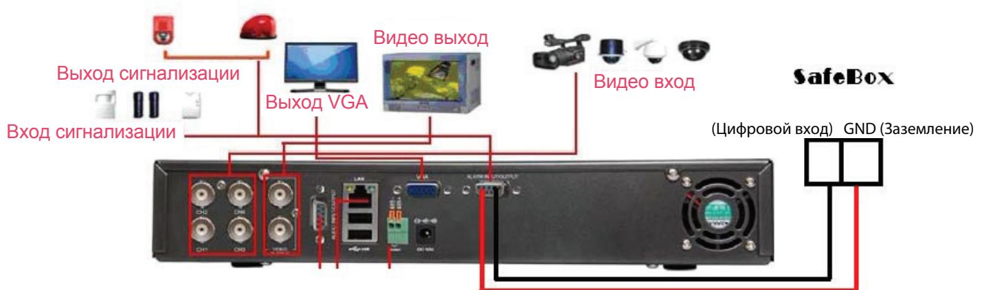
Подключение цифровогодвидеорегистратора с выходом сигнализации (NCZNO) к DIN и GND в T-100
